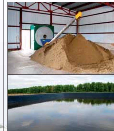
Hnojná koncovka na farme v Passvete je tiež veľmi progresívna. Hore je separátor. Tuhá časť sa po separácii podstieľa pod dojnice na gumenej matraci. Tekutá časť po separácii končí v skladovacích lagúnach a je podľa potreby a možnosti vyvážaná na niektorú z parcel v celkovej výmere 4 000 ha.
